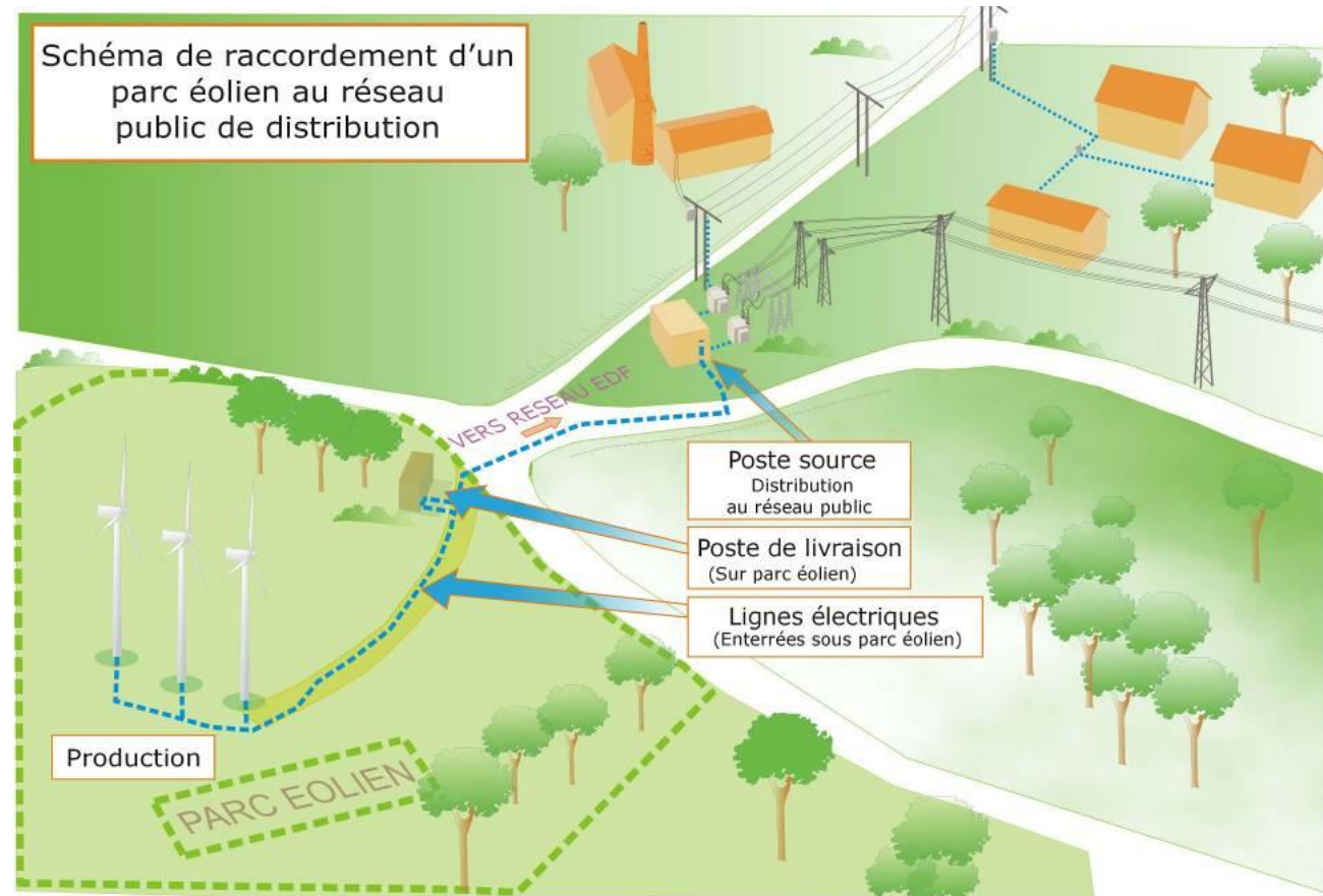
Figure 4 : Composants du parc éolien
